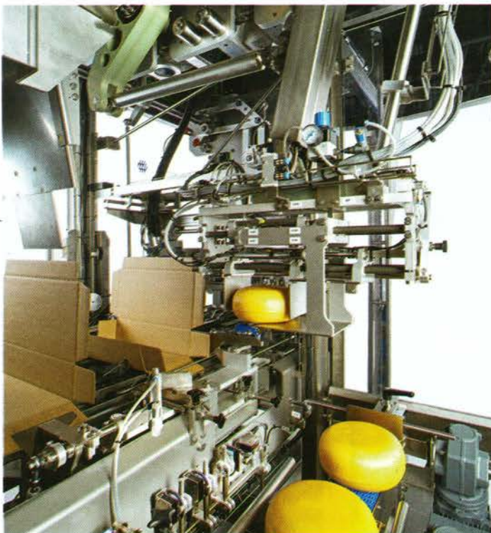
Das Greifsystem des Wrap-around-Packers 3100 s von Sema Systemtechnik kann ohne Umstellung unterschiedlichste Blockkäse-Geometrien handhaben (Foto: Sema Systemtechnik)
